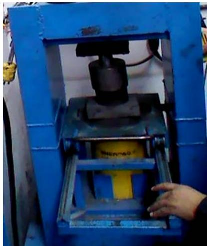
**Figura 2.4 Prensa y molde para compactación de polvos**
