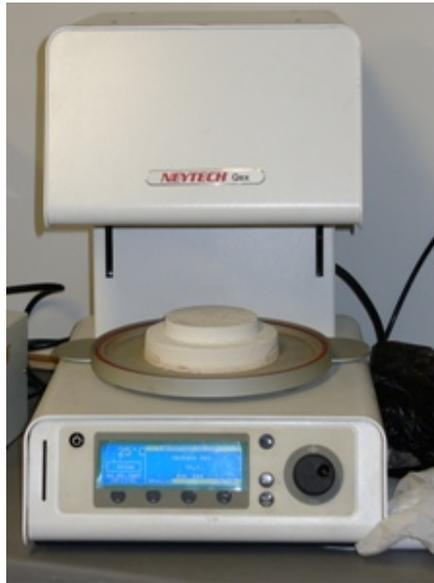
**Figura 2.5 Horno NEYTECH programable para tratamientos térmicos.**
