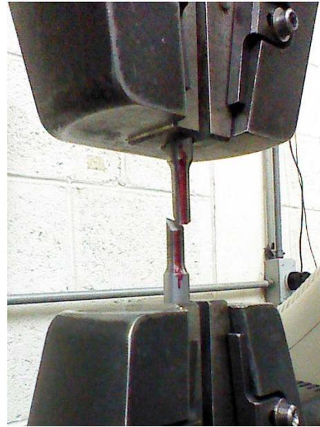
**Figura 2.11 Barra fracturada por tensión**
