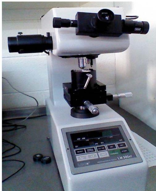
Figura 2.8 Microdurómetro vickers LECO LM300AT
