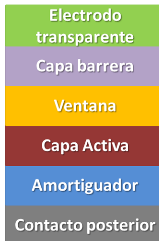
Figura 39 Representación de las capas que constituyen una celda solar.
