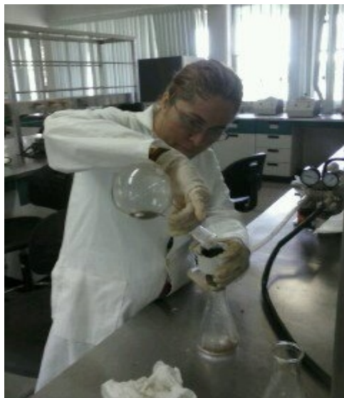
Figura 51 Se vierte la solución ya exfoliada en embudo Buchner
