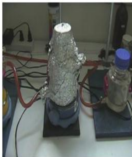
Figura 2.5 Reactor empleado en la técnica deposición - precipitación
