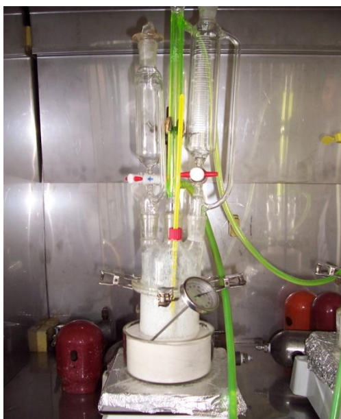
Figura 2.1 Sistema de síntesis Sol-Gel
