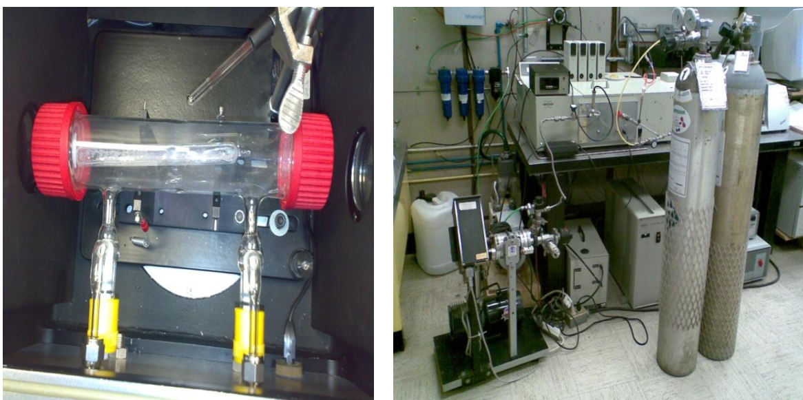
Figura 2.7 Sistema de evaluación fotocatalítica del equipo Bruker IFS66v/s
