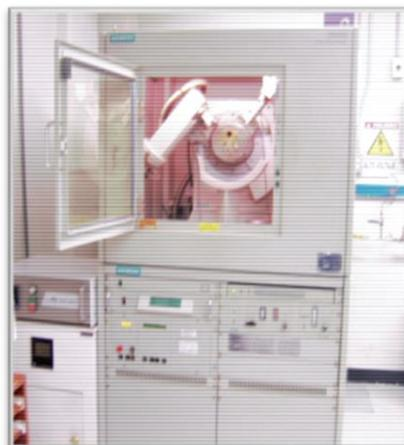
Figura 24. Equipo DRX SIEMENS D5000
