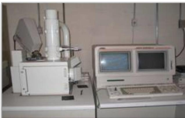
Figura 25. Microscopio Electrónico de Barrido JSM-5800 LV
