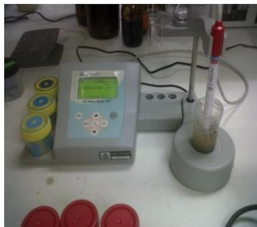
Figura 19. Equipo Crison EC-Meter Basic 30+
