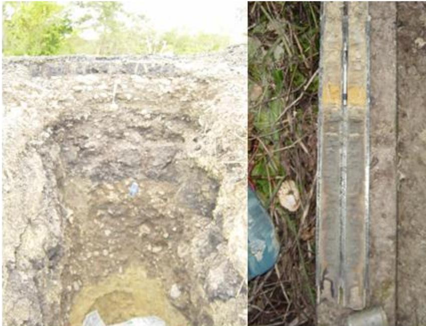
Fig. 11.- Sondeo a cielo abierto en el hombro del camino (izquierda) y muestreo de penetrómetro estándar.
