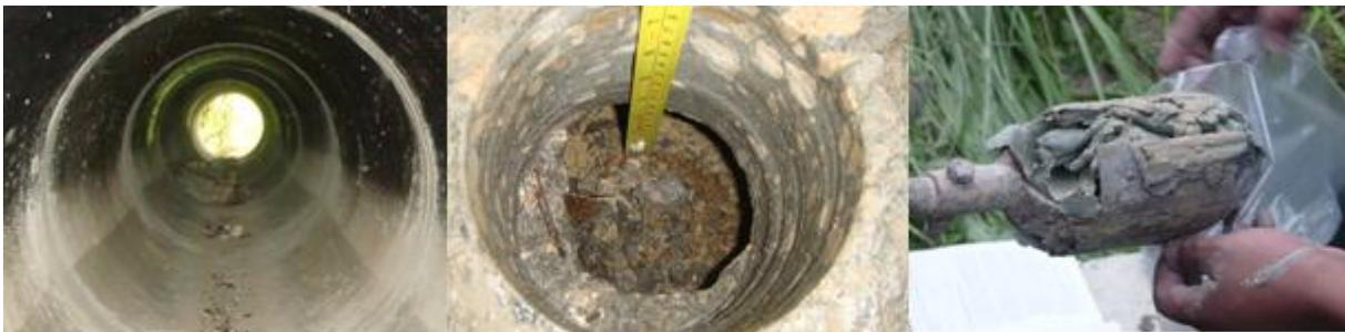
Fig.12.- Marcas de humedad en estriaje (izquierda), separación piso-terreno natural (central) y recuperación de muestras con posteadora (derecha).
