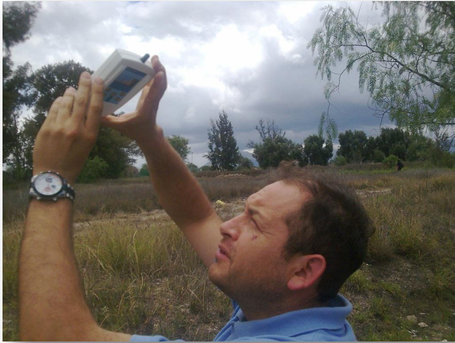
Figura 3.2.1. Medición de la radiación solar en campo.
