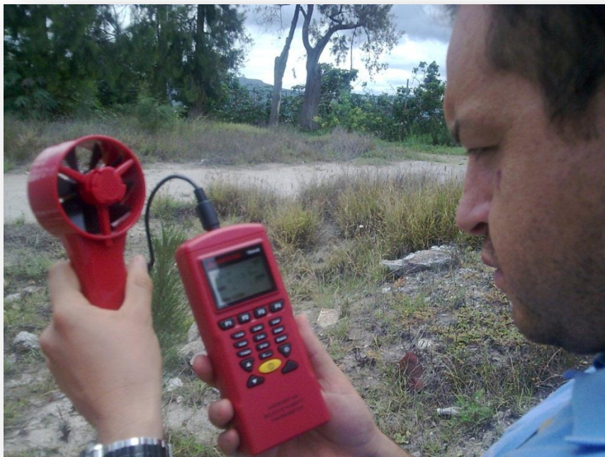
FIGURA 3.4.1. Medición de temperaturas del fluido de trabajo (Aire)
