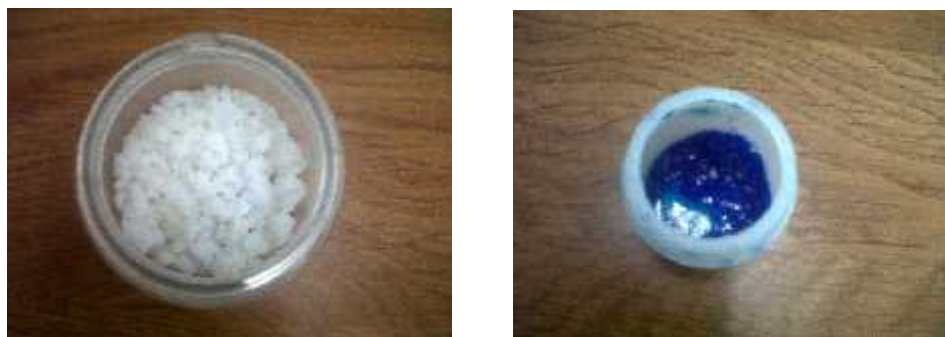
Figura 2. \text{SiO}_2 como soporte y \text{Cu}(\text{NO}_3)_2 como precursor
