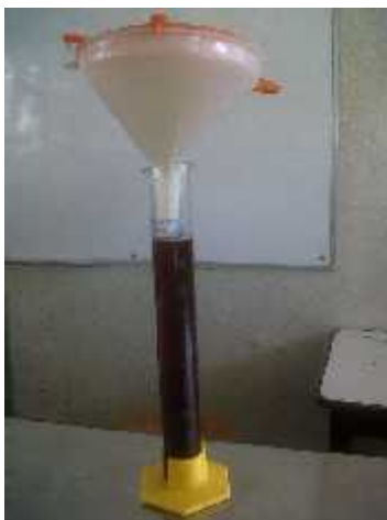
Figura 5. Filtración de sólidos suspendidos en el aceite usado de cocina
