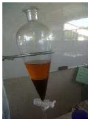
Figura 13. Separación de Biodiesel y residuos
