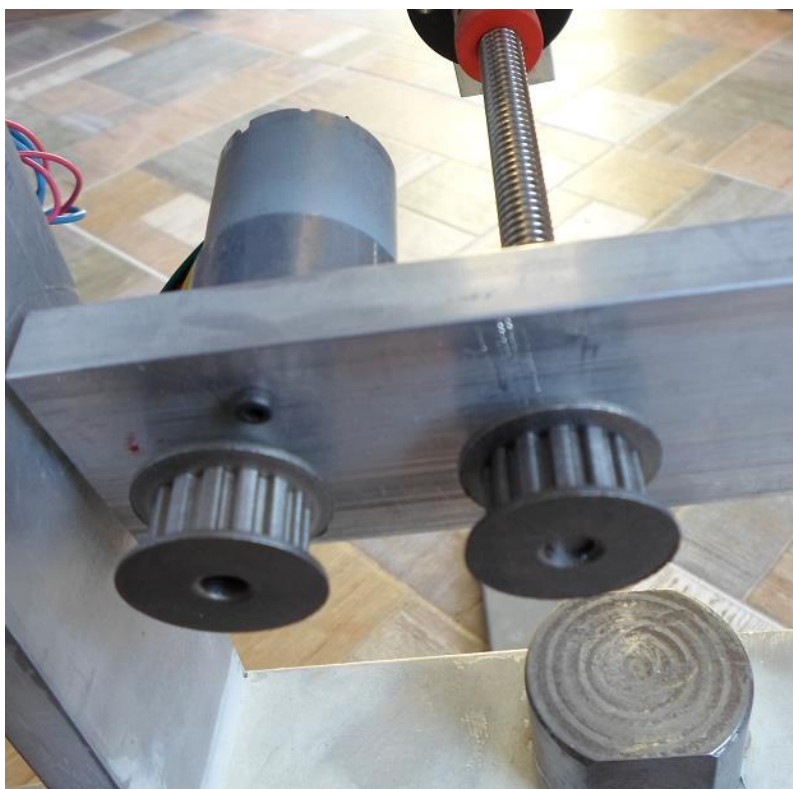
Ilustración 30 Detalle de la transmisión del motor y el tornillo Acme
