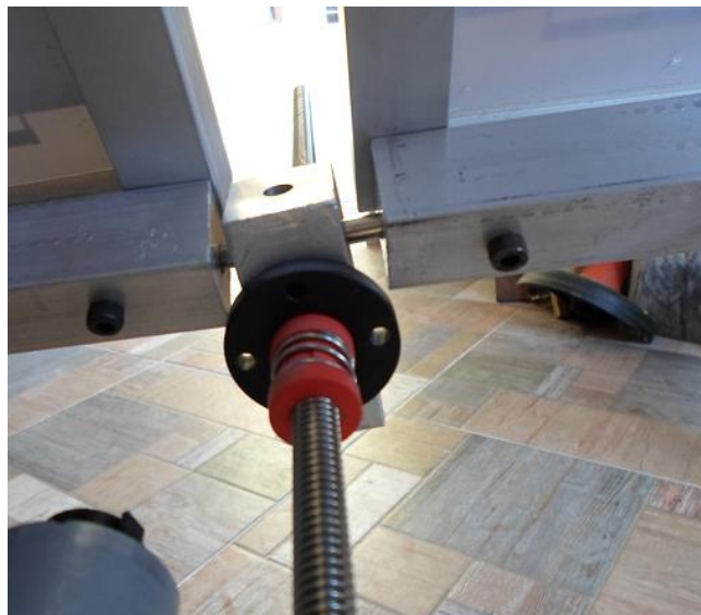
Ilustración 29 Cuerda "Acme", y tuerca con juego cero
