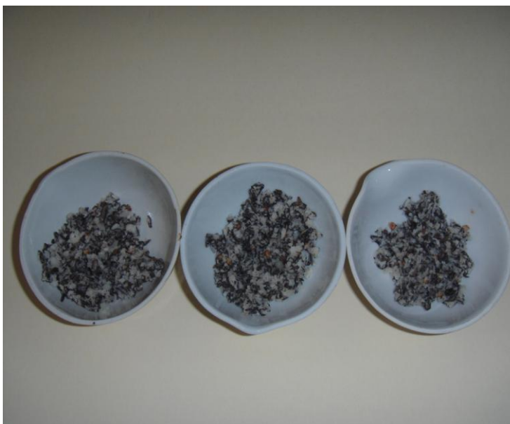
Figura. Crisoles con muestra para humedad.
