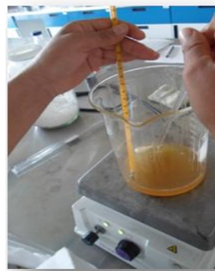
Figura 4. Mezcla de etoxido y aceite para la producción de biodiesel.
