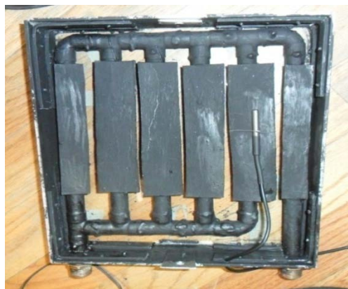
Figura 5. 12. Aletas y sensor de temperatura
