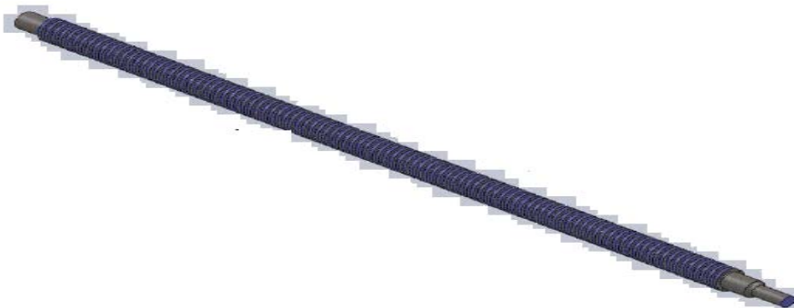
Figura 6. 8 Tornillo con cuerda ACME
