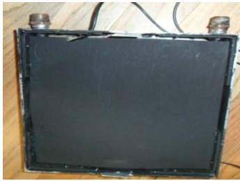
Figura 5. 13. Placa de absorción
