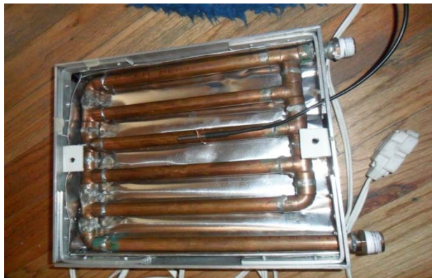
Figura 5. 1. Primer diseño del calentador suave
