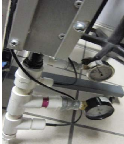
Figura 5. 16. Medidores de presión y temperatura de entrada y salida
