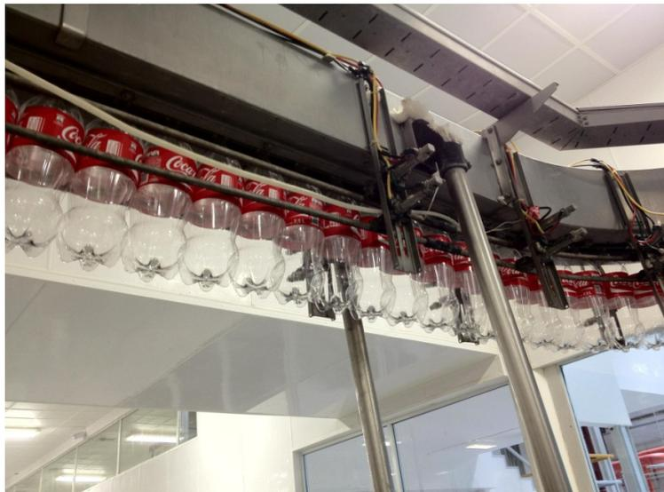
Figura 26. Desperdicio de aire comprimido en transportador línea 4.
