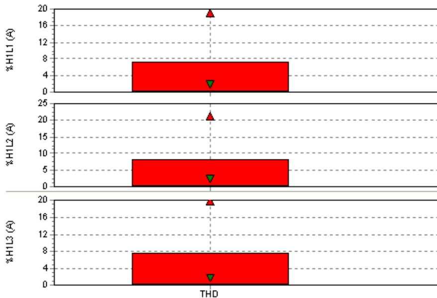
Figura 38. Espectro Armónico de Corriente (THDi) Transformador 1.
