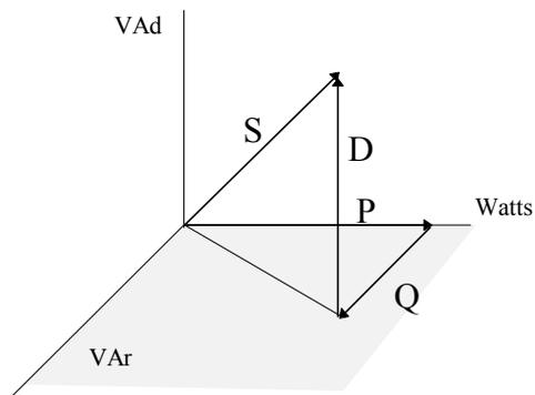
Figura 14. Potencia de distorsión armónica.
