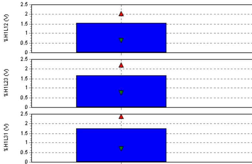
Figura 37. Espectro Armónico de Voltaje (THDv) Transformador 1.
