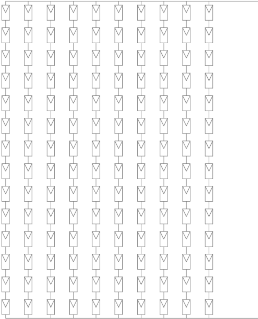
Imagen 2.4.1. Arreglo de paneles fotovoltaicos.
