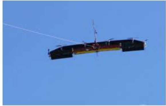
Imagen 4. Aerogeneradores a base de sistemas multi-ala y ala delta.
