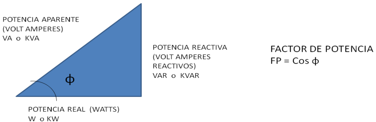
Figura 6 Triángulo de potencias.
