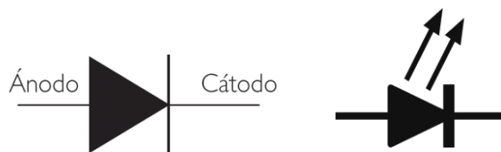
Figura 18 Símbolos de diodo rectificador y diodo emisor de luz LED. (De izquierda a derecha)
