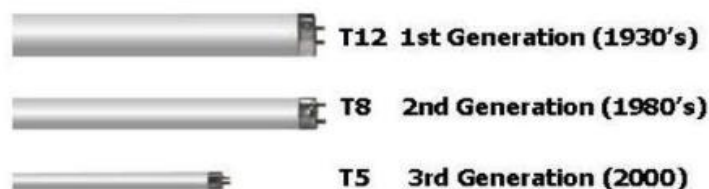
Figura 17. Clasificación de las lámparas fluorescentes.
