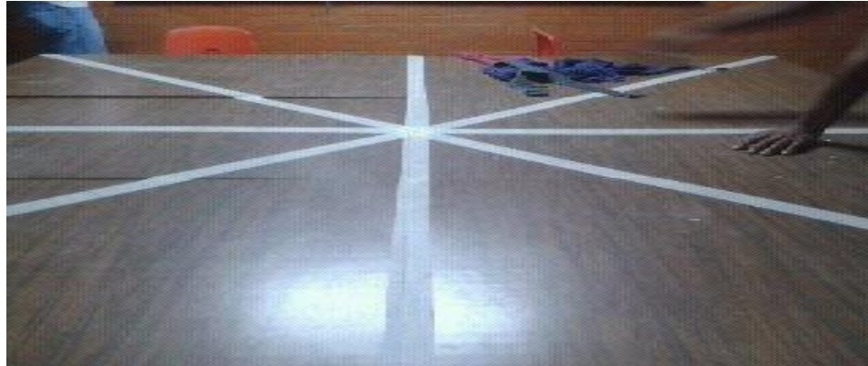
Figura37. Mesa con indicadores de segmentación angular para medición, de acuerdo a la NOM-25.
