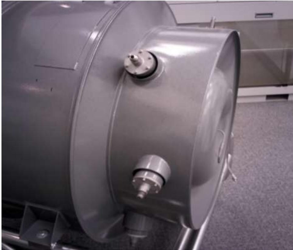
*Fig. 19 Microturbina Capstone. Vista de los inyectores de combustible*
