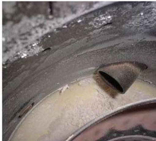
*Fig. 47 Ejemplo de daños provocados por altas concentraciones de Siloxanos en las turbinas.*
