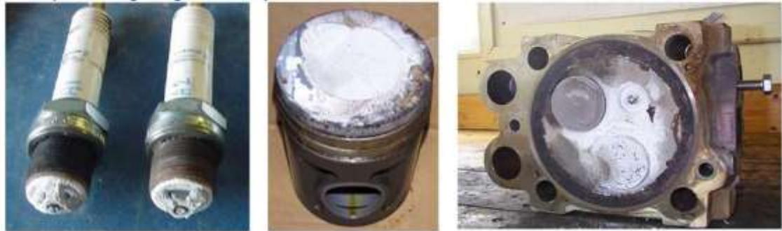
*Fig. 46 Ejemplo de daños provocados por altas concentraciones de Siloxanos en motores reciprocantes.*
