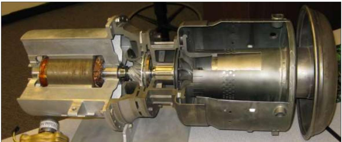
Fig. 26 Se muestra el interior de una microturbina. Cortesía Capstone y DTC Ecoenergía, 2012
