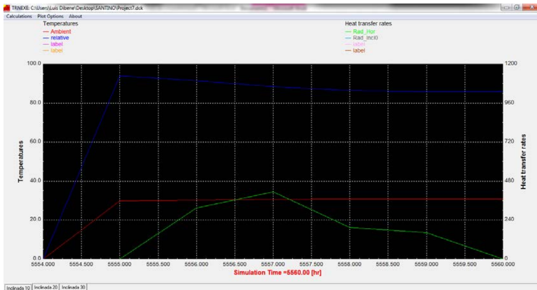
Fig. 30. Pantalla de la simulación en TRNSYS 16 de la Tbs (°C), HR (%) y radiación horizontal (W/m 2 ) para la ZMPV.
