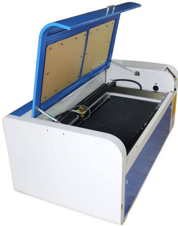
Figura 27 Cortadora Laser Buyer de 100W, La cual corto el material de acrílico para formar las piezas que se utilizaron para crear el prototipo tres.
