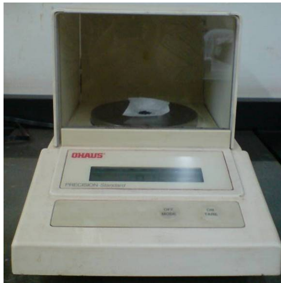
Figura 3.2. Balanza Marca Ohaus, modelo TS200S, de 200 g de capacidad y con una sensibilidad de 0.001 g, utilizada para pesar los óxidos.
