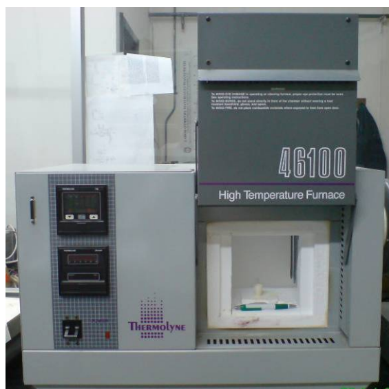
Figura 3.3. Horno Thermolyne 46100 utilizado para tratar la muestra térmicamente a 1000, 1020 y 1040^\circ\text{C} (tratamientos térmicos intermedios).
