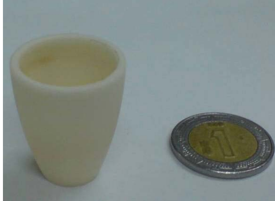
Figura 3.4. Crisol de alta alúmina utilizado durante los tratamientos térmicos intermedios.
