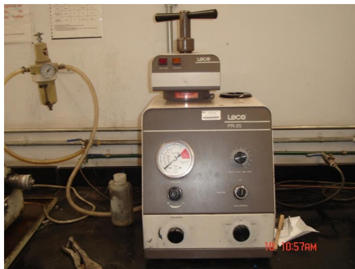
Fig.4. Máquina montadora utilizada para embriquetar en baquelita las piezas de acero al boro.
