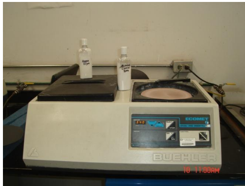
Fig.5. Máquina pulidora utilizada para desbastar y pulir las muestras embriquetadas.
