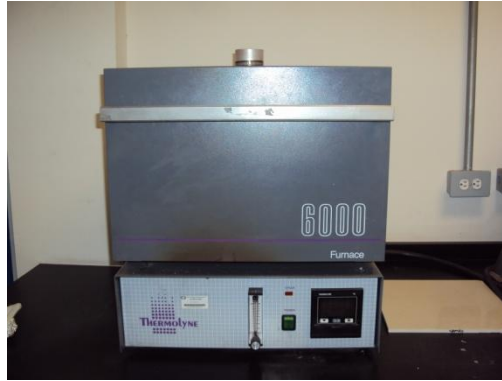
Fig.2. Mufla Thermolyne en la que se llevaron a cabo los tratamientos térmicos del acero al boro.
