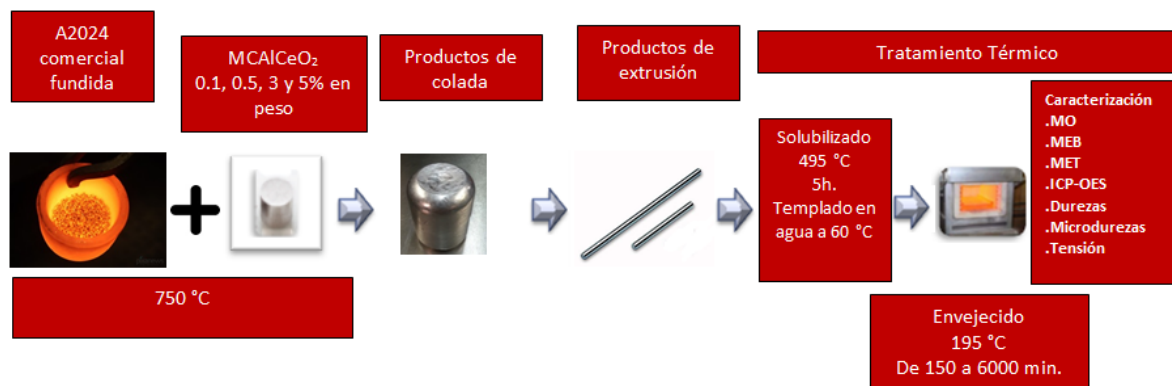
Figura 13. Proceso de síntesis de la aleación A2024 reforzada con el MCAICeO 2
