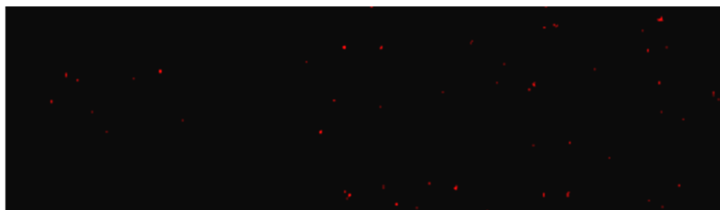
Figura 55. Mapeo hiperespectral de Ag de las nanogalletas de ZnO con 5% de Ag.
