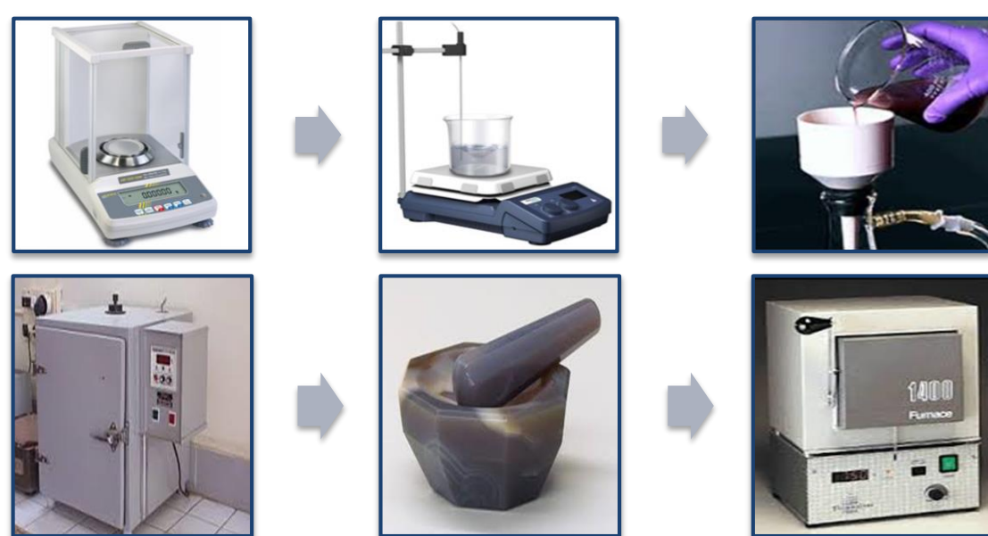
Figura 1. Diagrama de flujo en la síntesis de CuWO_4 , CoWO_4 , MnWO_4 y NiWO_4 .
