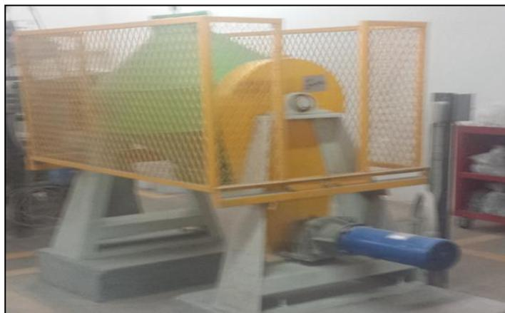
Fig. 6 Mezclador de mezclas crudas.
