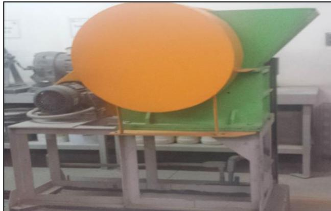
**Fig. 3 Trituradora de quijadas marca Bico.**
