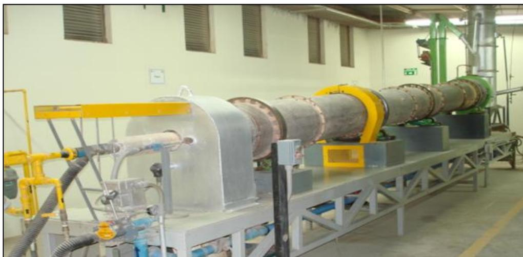
**Fig. 7 Horno rotatorio piloto.**
