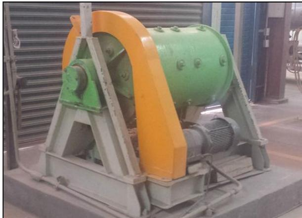
**Fig. 8 Molino de bolas, cemento**
