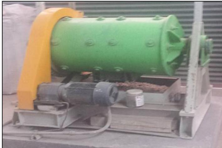
Fig. 5 Molino de bolas, mezcla cruda
