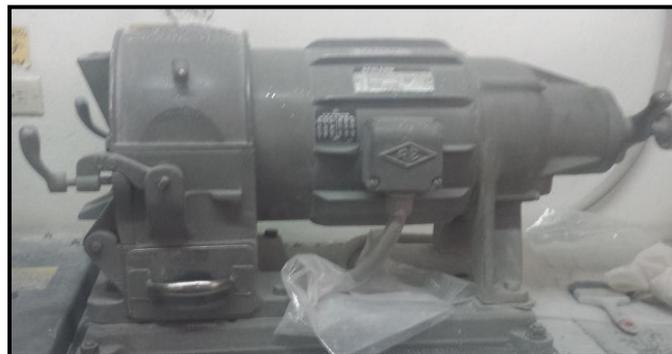
**Fig. 4 Pulverizador de discos marca Bico.**
