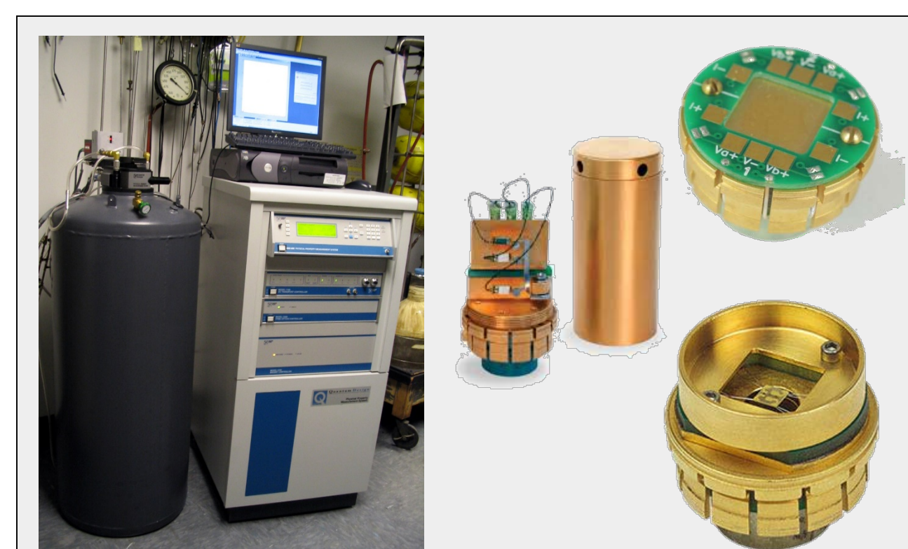
Physical Property Measurement System (PPMS) y las sondas de medición disponibles para medir las propiedades de transporte en el CoSb 3 .
